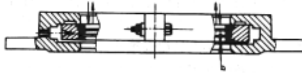
图 3.6.2 密封瓦在瓦座内的轴向间隙示意图
